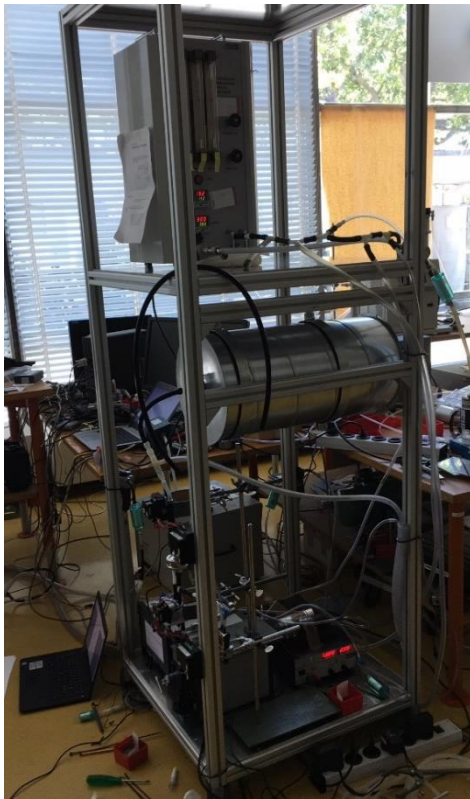
Abbildung 3: Messaufbau für die Abschätzung der Filtereffizienz
